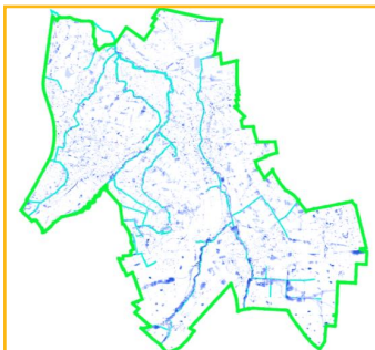
Gesamtes Stadtgebiet - extremer Starkregen mit der statistischen Wiederkehrzeit von 1 mal in 200 Jahren. (Starkregenindex SRI 10)
